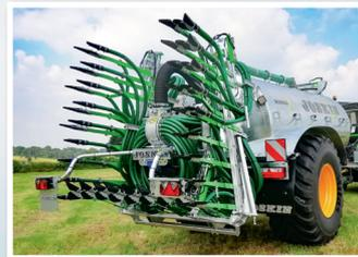
• BASIC: гидравлическое раскладывание (3 части)
